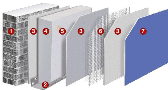
1. Muro Soporte 2. Perfil de arranque 3. Mortero Base Ligero BEISSIER 4. Aislamiento de NEOPOR® EPS 5. Espiga-Tacos de Polipropileno 6. Malla de fibra de vidrio 7. Sistema Granocryl (BRS SL03, BRS SL07, BRS SL10, BRS SL15, BRS SL15 LOTO), Betaelastic, Betaelastic Mate.
