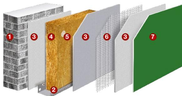
1. Muro Soporte 2. Perfil de arranque 3. Mortero Base Ligero BEISSIER 4. Aislamiento de Lana de Roca 5. Espiga-Tacos de Polipropileno 6. Malla de fibra de vidrio 7. Sistema Granocryl (BRS SL03, BRS SL07, BRS SL10, BRS SL15, BRS SL15 LOTO), Betaelastic, Betaelastic Mate.
